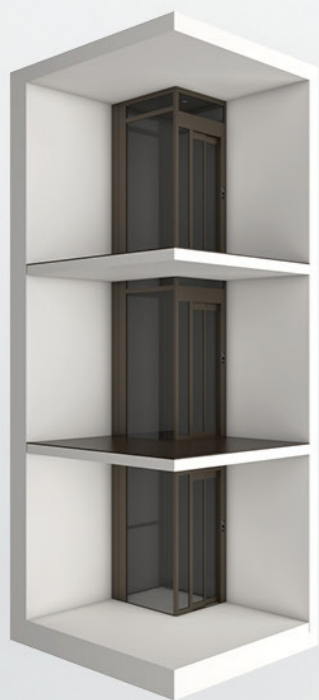
楼板中空(靠墙)
