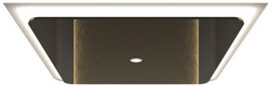
HWD-144 艺术合金板、黑钛镜面不锈钢、暗藏灯带、筒灯
